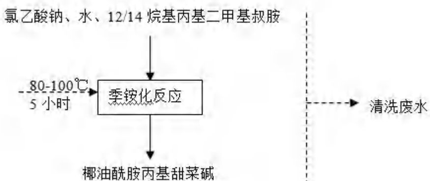
图 4.1-2 甜菜碱系列两性离子表面活性剂生产工艺流程及产污位置图
